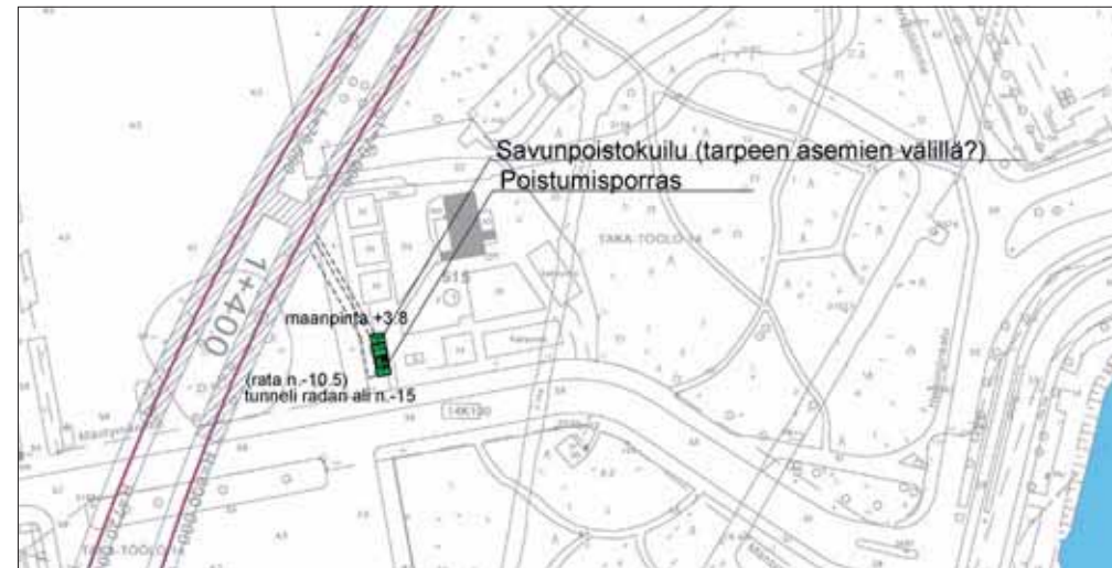
Kuva 1.35. Stadionin etukentän pystykuilu (kaikissa vaihtoehdoissa).
